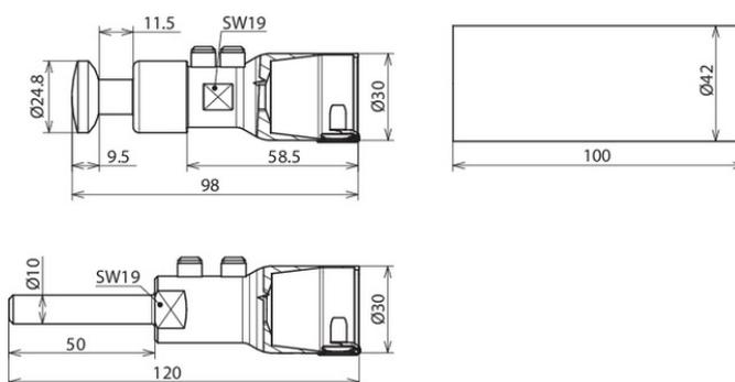
Anschlusselemente zum Abschließen der HVI power long Leitung an beiden Enden, beim Erstellen des Endverschlusses der Leitung im Stützrohr (Kopfstück) und Anschlusselement zum Anschließen an andere Teile des äußeren Blitzschutzes oder der Erdungsanlage (inkl. zwei Schrumpfschläuche).
