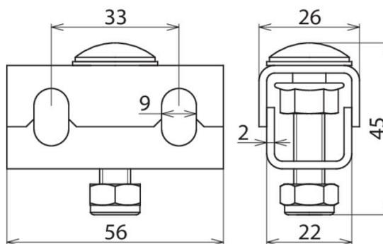
PA-Klemme (PAK) Kabelbahn
