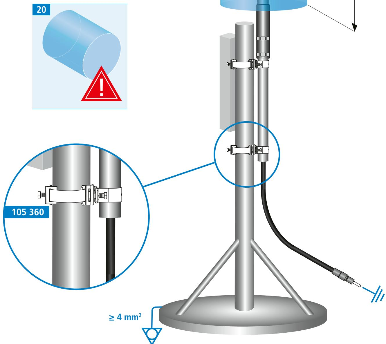
**DE** Stützrohr-Montage im Drei- oder Vierbeinstativ
