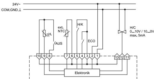
Anschluss im 4-Rohr-Leitungssystem (siehe auch Punkt 9., Jumper 1)
