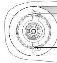
Einstellfahne für maximalen Temperaturwert
