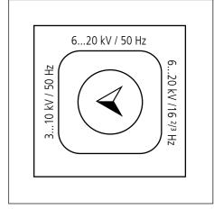
Bild 2: Nennspannungswahlschalter (nur Art.-Nr. 767 416)
