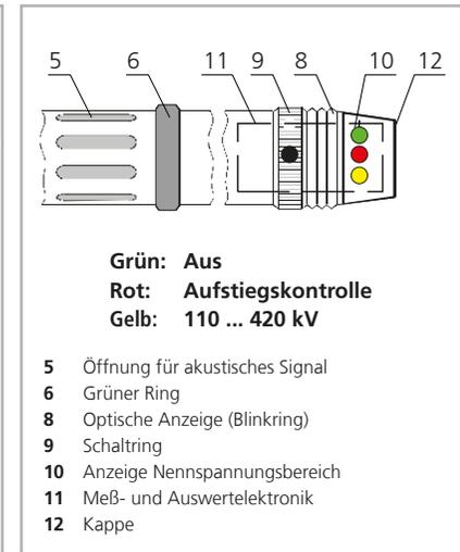
**Bild 5** Arbeitskopf mit Anzeigeteil
