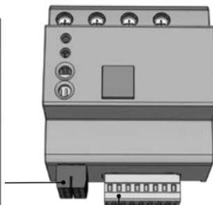
Zur Entriegelung der Push-In-Anschlüsse wird ein Schlitz-Schraubendreher (≤ 2,5 mm) benötigt
