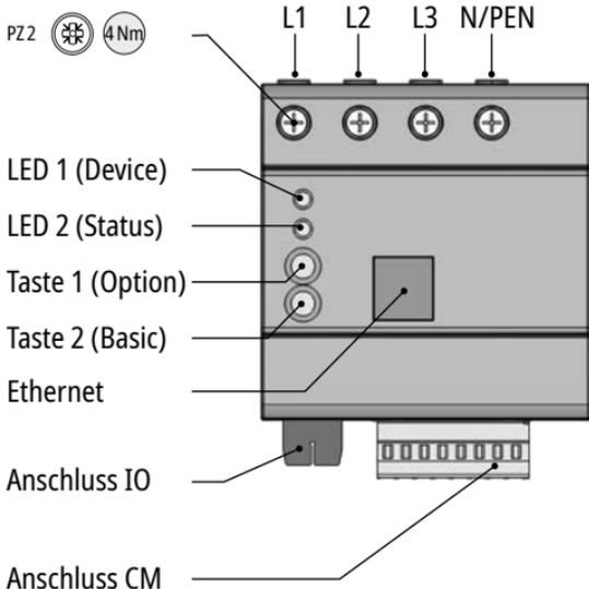
**Achtung!** Der Anschluss der Stromsensoren am Gerät muss **vor** der Montage am Stromleiter erfolgen!
