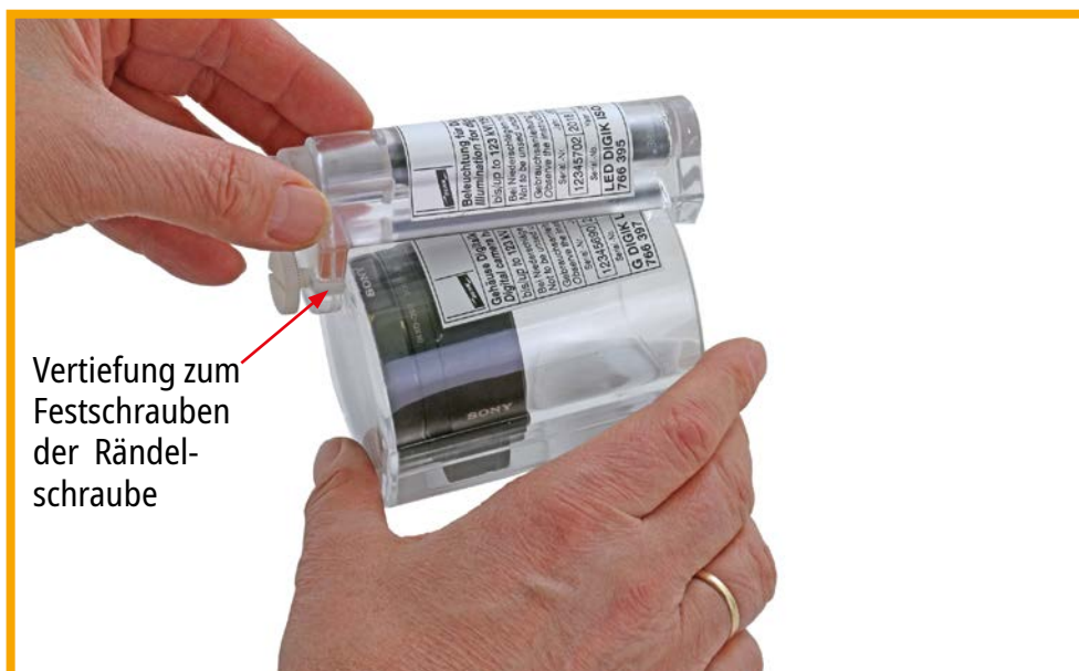
Bild 5 LED-Gehäuse auf das Kameragehäuse aufsetzen
